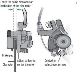
Si el rotor siempre roza contra la pastilla de freno o el espacio es demasiado grande, afloje los dos tornillos de ajuste de centrado, pero no los quite. Gire lentamente la rueda y verifique el espacio entre el rotor y la pastilla de freno; ajustar la posición de la pastilla de freno y el rotor. Centrar el rotor y las pastillas para evitar roces. Después de completar el ajuste, apriete el
