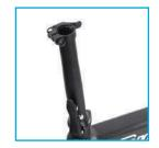
Insertar el tubo en el manubrio y cerrar. Entonces instale el reflector en el manillar. (Herramienta 3)
