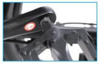
Asegúrese de que las roscas de cada pedal estén completamente dentro del brazo de la biela.
